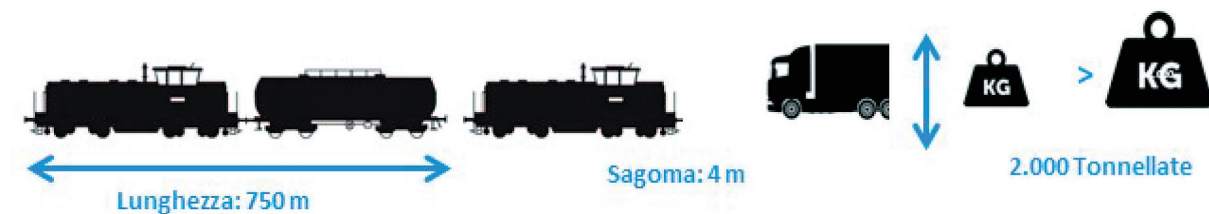
Figura 31 – Le caratteristiche del Treno Europeo Merci. Figure 31 – The characteristics of the European Freight Train.
