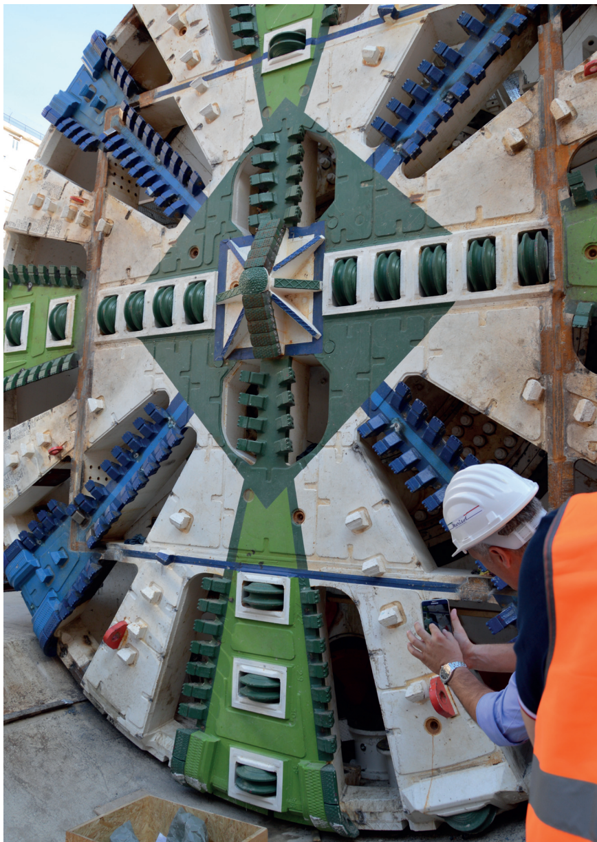
Fig. 3 - La ruota di taglio all'aperto nel 2016 durante il montaggio della TBM Marisol.
