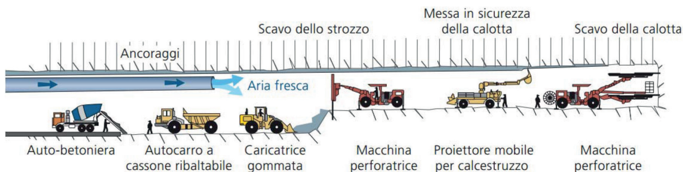
Fig. 20 - Avanzamento convenzionale con esplosivo. Fig. 20 - Progress with explosive.
