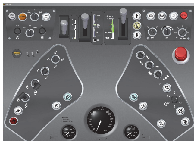
Fig. 8 - Interfaccia grafica della VCS con i comandi del banco di manovra.
