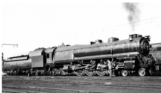
Fig. 1 – La locomotiva sperimentale N-1 5600 della Baltimore & Ohio a Washington, D.C., 1938. I cilindri posteriori erano posizionati sotto la parte anteriore del forno. The experimental locomotive N-1 5600 of Baltimore & Ohio at Washington, D.C., 1938. The rear cylinders were positioned in the front part of the firebox.
