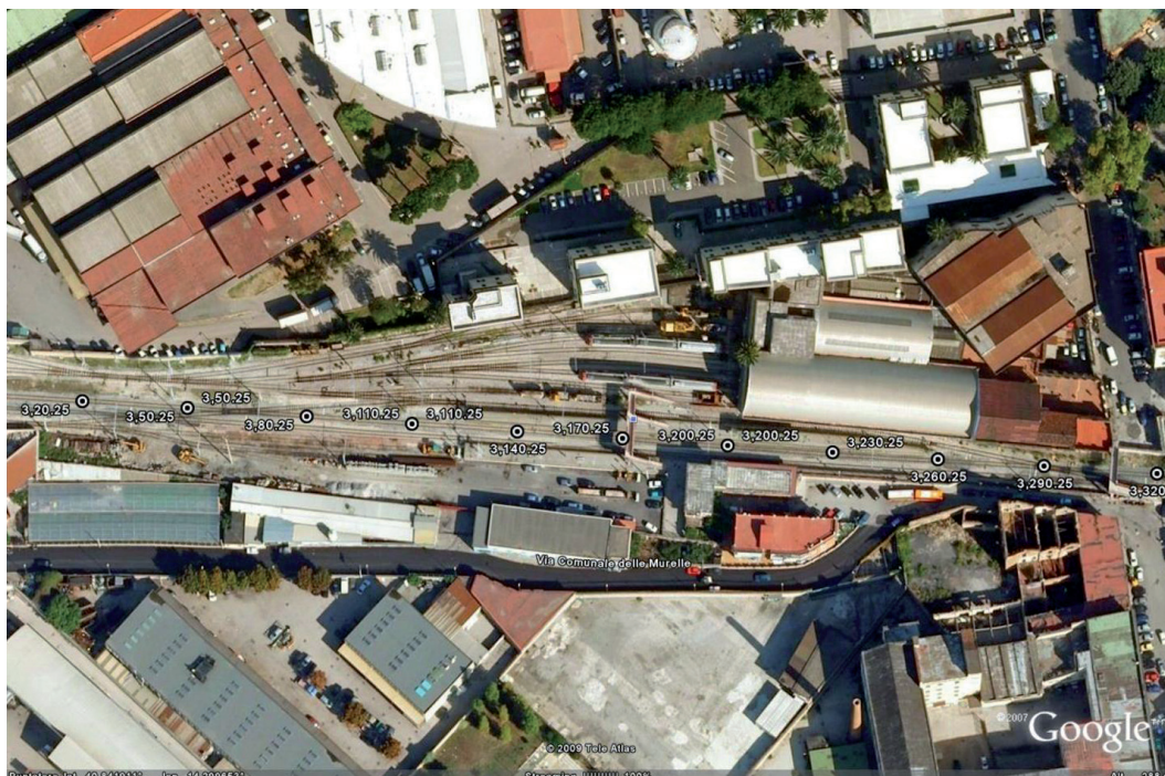
Fig. 20 - Nella foto è possibile riconoscere i deviatori in questione, e la distanza di 260m circa tra il primo deviatore di ingresso in stazione e il secondo di uscita. In the picture you can recognize the switches in question, and the distance of about 260m between the first switch point at station entrance and the second behind station exit.
