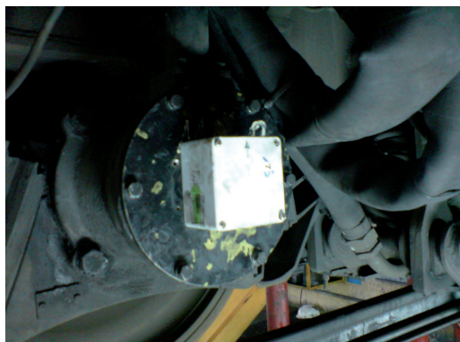
Fig. 2 - UF installata sul piatto del sensore di velocità. FU installed on the plate of the speed sensor.
