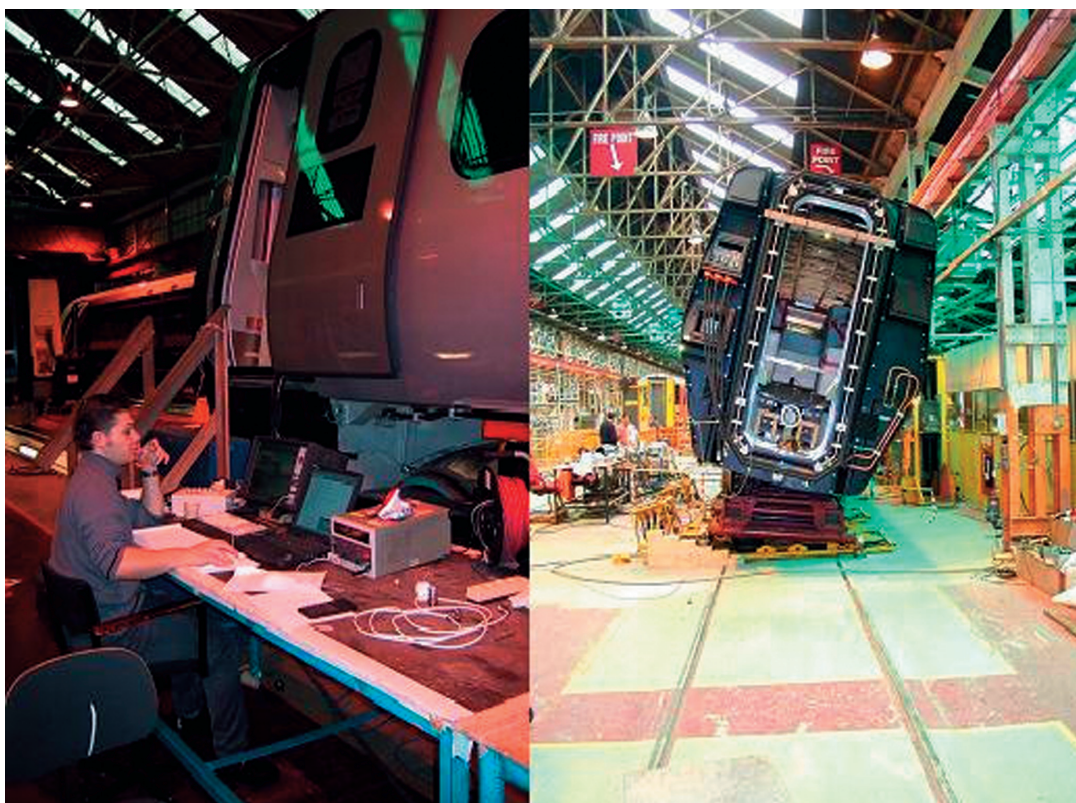
Fig. 8 - Esempio di utilizzo simulatore in messa in servizio di singolo veicolo.
