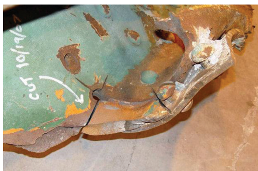
Fig. 10 - I35W, crollo del ponte sul fiume Mississippi, Missouri (2007): dettaglio di alcune cricche diffuse da un giunto rivettato. I35W, collapse of the bridge on the Mississippi river, Missouri (2007): some crack detail on a riveted joint.
