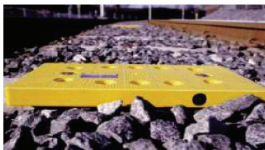
Fig. 12 - Utilizzo promiscuo della Eurobalise ed Encoder SCMT per l'invio dei telegrammi SCMT ed ETCS Livello 1 ai treni. Mixed use of SCMT Eurobalise and Encoder for the transmission to the trains of the SCMT and Level 1 ETCS telegrams.
