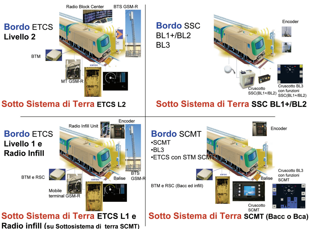
Fig. 7 - Architetture di sintesi dei sistemi ETCS (Livello 2 e Livello 1 con Radio Infill), SCMT ed SSC. Outline of ETCS (Level 2 and Level 1 with Radio Infill) system Architecture.
