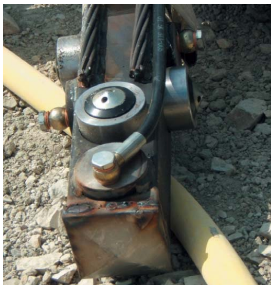
Sistema TFEG - Applicazione su tirante attivo.
