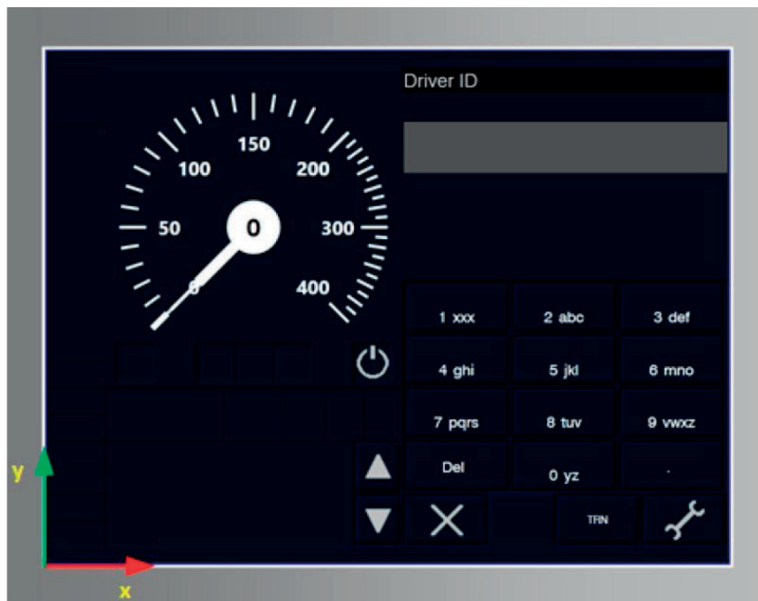
Figura 2 – Sistema di riferimento del piano di lavoro del display DMI. Figure 2 – Reference system for the workplane of the DMI display.
