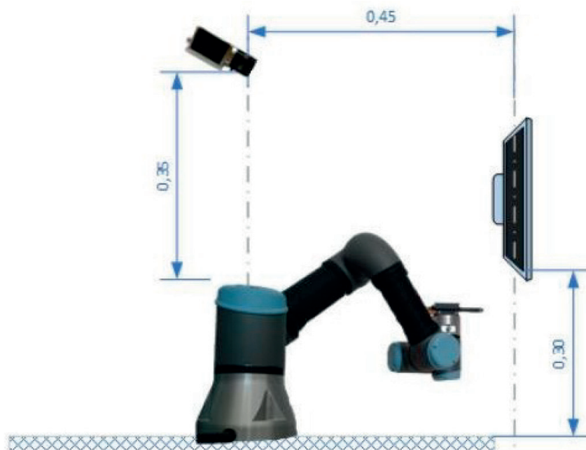
Figura 1 – Posizionamento dei componenti del sistema di test DIS.
