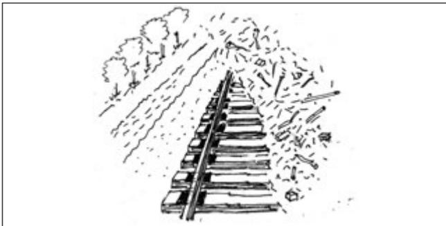
Fig. 11 - Trasporto di detriti sul binario a seguito del suo allagamento per esondazione.
