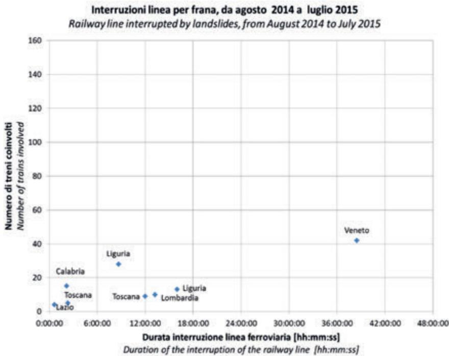
Fig. 14 - Interruzione della linea ferroviaria per frana.
