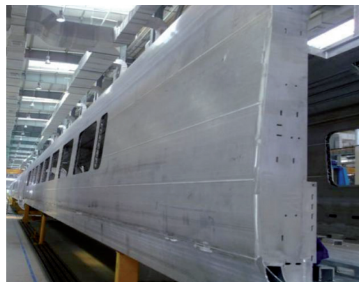
Fig. 3 - Esempio della struttura di una cassa ferroviaria in alluminio e saldata mediante FSW.
