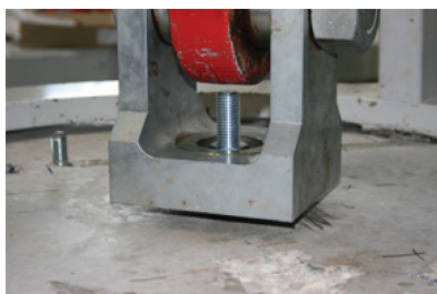
Fig. 6 - Particolare aggancio barra. Detail of bar hooking.
