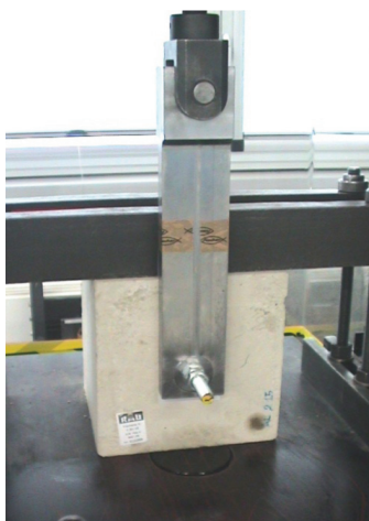
Fig. 11 - Dispositivo di prova per sollecitazione di taglio. Test device for shear stress.
