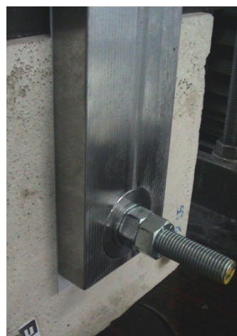
Fig. 12 - Particolare del collegamento. Detail of the connection.
