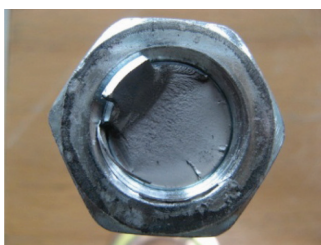
Fig. 7 - Superficie di frattura, con innesco della cricca in corrispondenza del primo filetto in presa, sotto il dado (barra filettata M20). Fracture surface with crack initiation in correspondence of the first connection thread, underneath the nut (M20 threaded bar).
