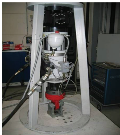
Fig. 5 - Dispositivo di prova per sollecitazione di trazione. Test device for tensile stress.
