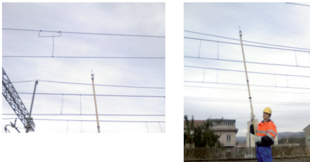
Fig. 16 - Foto relativa alla posizione del rilevatore durante la prova lungo un binario secondario di una stazione. Picture showing the detector position during the test along a secondary track of a railway station.
