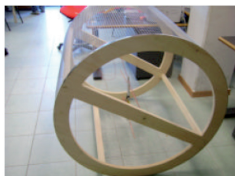
Fig. 11 - Gabbia di Faraday, utilizzata come schermo per lo studio del rilevatore. Faraday cage, used as shield for the detector study.
