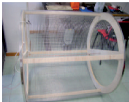
Fig. 11 - Gabbia di Faraday, utilizzata come schermo per lo studio del rilevatore. Faraday cage, used as shield for the detector study.
