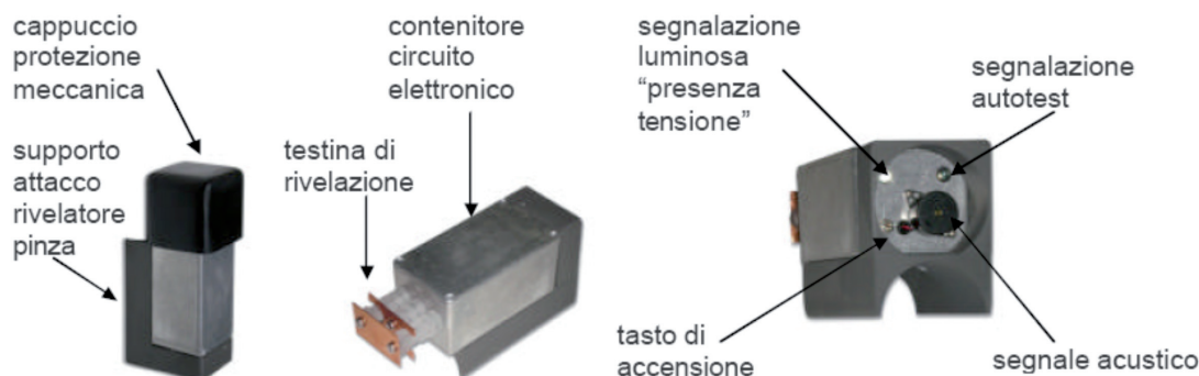
Fig. 14 - Dispositivo di rilevamento di presenza/assenza tensione adattato, per effettuare le prove in cabina e in linea. Voltage presence/absence detector device able to perform both box and line tests.
