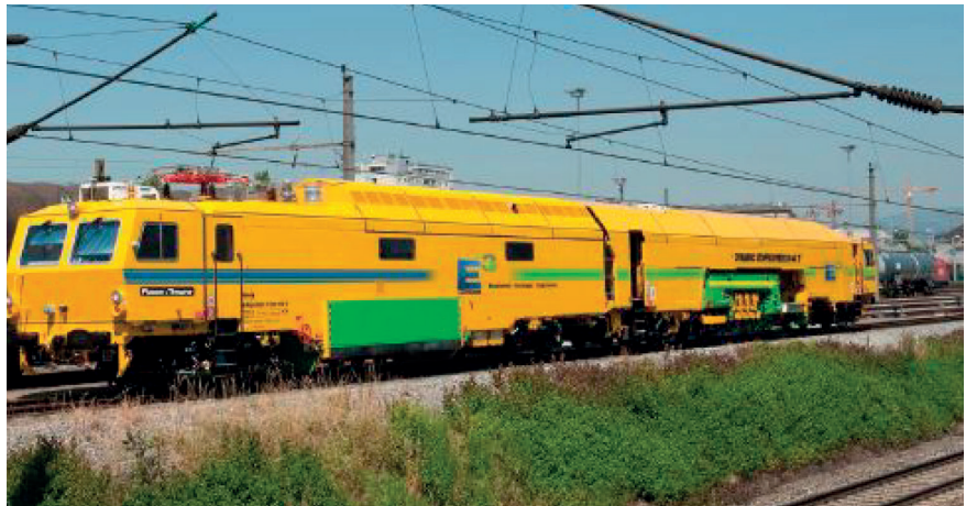
Fig. 6 - Il veicolo con STB (6764) predisposto ad essere upgradato con ETCS liv. 2.
