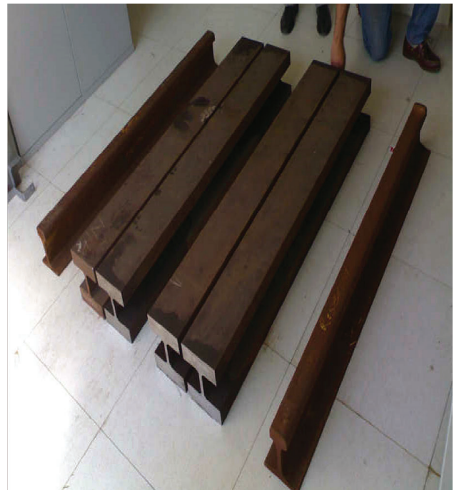
Fig. 2 - Schema dello spezzone di ponte da 1,5 m riprodotto in Laboratorio.
