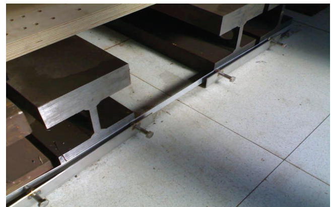
Fig. 3 - Dettaglio del collegamento elettrico effettuato tra le travi.
