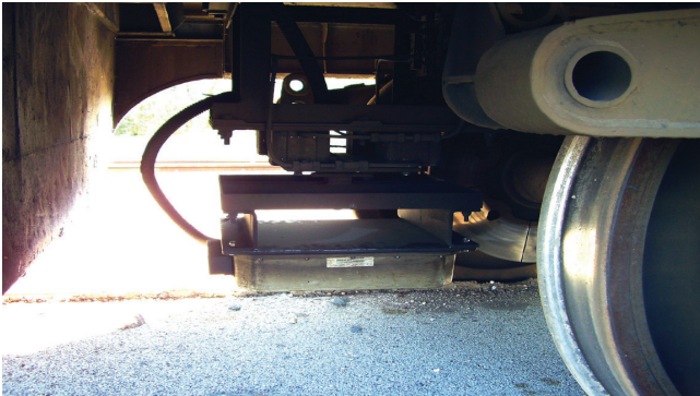
Fig. 25 - Esempio installazione AEB Ansaldo sotto-cassa. Fig. 25 - Example of the AEB Ansaldo sub-box installation.
