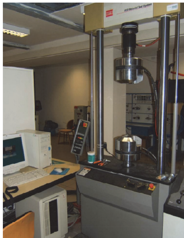
Fig. 1 - Macchina di prova MTS 810. Fig. 1 - Servo-hydraulic MTS 810 test system.
