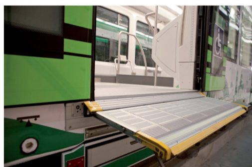
Fig. 6 – Rampa retrattile per un agevole accesso al veicolo tram-treno nelle stazioni ferroviarie convenzionali: a) vista generale delle porte; b) apertura della rampa; c) posizione finale della rampa prima dell'apertura delle porte; d) porte aperte con rampa retrattile dischiusa. Fig. 6 - Retractable ramp for easy access to tram-train in conventional railway stations; a) general view of the doors; b) ramp deployment; c) final position of the ramp before opening doors; d) doors opened with retractable ramp unfolded.
