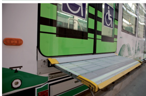
Fig. 6 – Rampa retrattile per un agevole accesso al veicolo tram-treno nelle stazioni ferroviarie convenzionali: a) vista generale delle porte; b) apertura della rampa; c) posizione finale della rampa prima dell'apertura delle porte; d) porte aperte con rampa retrattile dischiusa. Fig. 6 - Retractable ramp for easy access to tram-train in conventional railway stations; a) general view of the doors; b) ramp deployment; c) final position of the ramp before opening doors; d) doors opened with retractable ramp unfolded.
