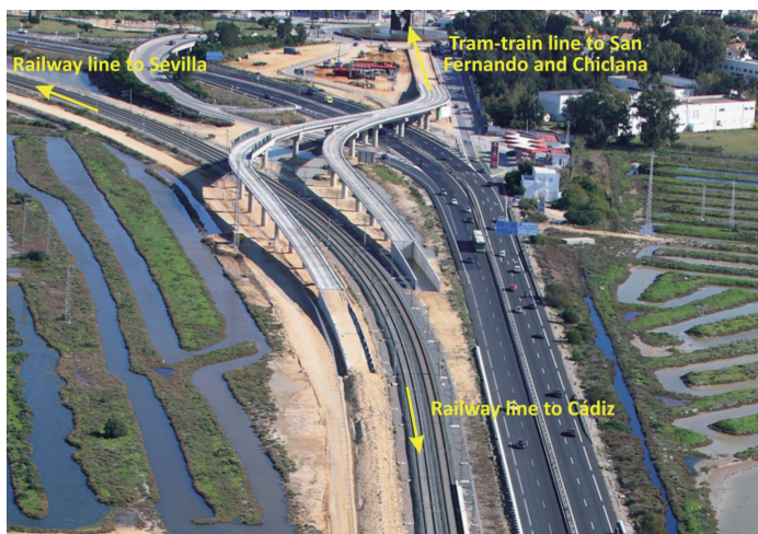
Fig. 2 – Connessione di La Ardila tra linea tram-treno e linea ferroviaria convenzionale esistente.
