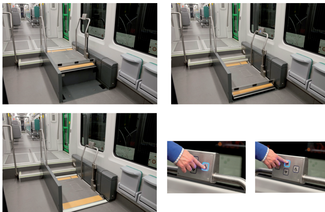
Fig. 5 – Ascensore interno del tram-treno di Cadice: a) quota superiore del pianale; b) posizione intermedia; c) quota inferiore del pianale; d & e) sistema di comando.
