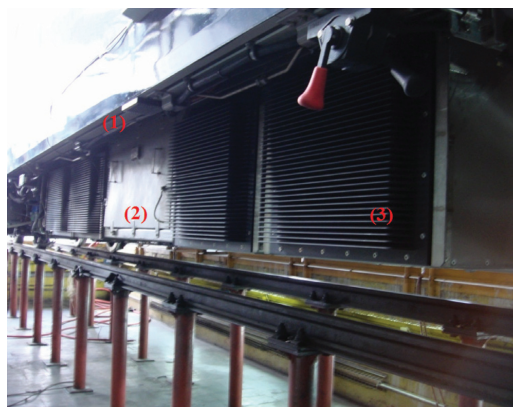
Fig. 21 – Particolare della disposizione moduli sottocassa: 1) telaio portante; 2) vano apparecchi; 3) moduli di fase.
