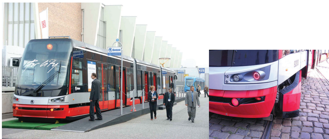
Fig. 25 - Tram tipo 15T ("ForCity") di Škoda, presentato a Innotrans 2008. Da qui al 2018 ne verranno costruiti 250 per la DPHMP di Praga. Il particolare a destra mostra il carrello che ruota rispetto alla cassa. Type 15T ("ForCity") tram by Škoda, presented at Innotrans 2008. From now to 2018, 250 will be produced for DPHMP of Prague. The pivoting bogie is shown in the detail on the right.
