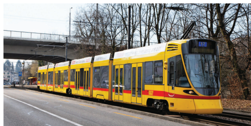
Fig. 24 - Tram "Tango" della Baselland Transport AG (BLT). I tre carrelli motori ruotano rispetto alle casse; i due carrelli portanti hanno \pm 2,5^\circ di libertà di rotazione rispetto ai carrozzini. "Tango" tram of Baselland Transport AG (BLT). The three motored bogies are pivoting; the two carrying bogies have a rotational freedom of \pm 2,5^\circ with respect to the articulation carriages.
