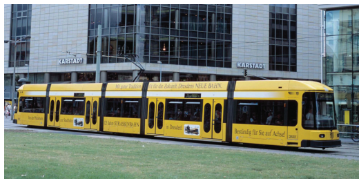
Fig. 21 - I primi tram della DVB di Dresda dopo la riunificazione della Germania sono stati i rotabili multiarticolati (sebbene a pavimento parzialmente basso) dei tipi NGT6DD (cinque casse su tre carrelli) e NGT8DD (sette casse su quattro carrelli), forniti a partire dal 1995. Nella foto è ripreso un NGT6DD (lunghezza 33,5 m). The first Dresden trams after the reunification of Germany were multi-articulated vehicles (even though partially low-floored) of types NGT6DD (five bodies on three bogies) and NGT8DD (seven bodies on four bogies), supplied since 1995. The photo shows an NGT6DD (33,5 m long).
