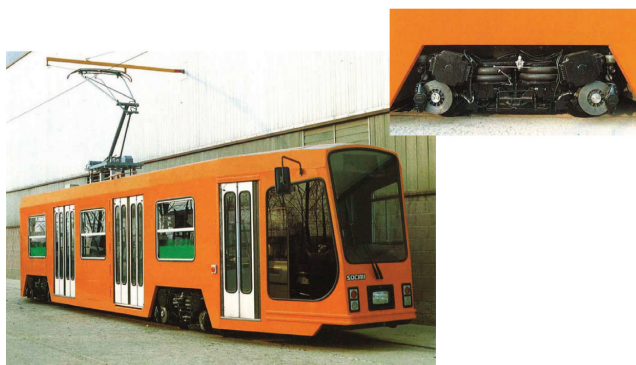
Fig. 4 - Il rivoluzionario prototipo S-350 LRV di Socimi del 1989. Per la prima volta al mondo presentava il pavimento basso (350 mm dal piano del ferro) per tutta la lunghezza del rotabile, ma manteneva carrelli che ruotavano rispetto alla cassa. The revolutionary S-350 LRV Socimi prototype dates 1989. For the first time in the world, it presented low floor (350 mm from T.o.R.) for the entire length of the vehicle, though maintaining pivoting bogies.
