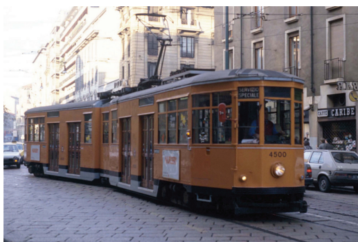
Fig. 1 - Il prototipo realizzato nel 1984 da Firema, con il finanziamento del CNR per il carrello portante a ruote indipendenti e la collaborazione dell'ATM di Milano, che mise a disposizione due tram tipo "1928" incidentati e due carrelli potenziati (e con il freno a pattini elettromagnetici!), è stato il primo tram al mondo con pavimento a 350 mm. The prototype developed by Firema in 1984, thanks to CNR funding (for the carrying bogie with independent wheels) and the collaboration of ATM Milan, that made available two damaged "1928" type trams, as well as two bogies (with increased power and electromagnetic track brakes), was the first tram in the world with the floor at 350 mm.
