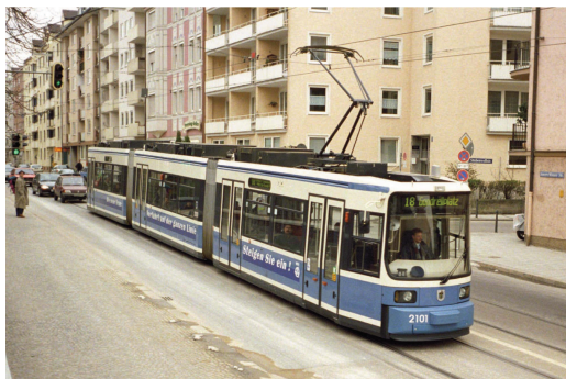
Fig. 7 - I GT6N/GT8N di AEG-MAN (ora Bombardier) sono stati i primi tram a pavimento tutto basso ad essere prodotti in serie, a cominciare dalla fornitura per Brema del 1993. La foto riprende la prima unità della serie di 70 della MVG di Monaco di Baviera (1994). Caratterizzati da un numero di carrelli pari a quello delle casse, questi tram presentano una certa libertà di rotazione fra cassa e carrello ( \pm 2,3^\circ ). The GT6N/GT8N by AEG-MAN (now Bombardier) were the first fully low-floor trams to be mass produced, starting from the supply to Bremen in 1993. The picture captures the first unit of the 70-tram series of MVG, Munich (1994). These trams, which feature a number of bogies equal to that of the carbody, present a certain degree of rotational freedom between the body and the bogie ( \pm 2,3^\circ ).
