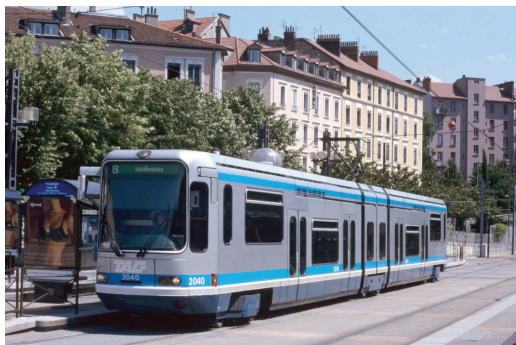
Fig. 2 - Due classici tram a pavimento parzialmente basso della prima generazione: a sinistra il TSF (Tram Standard Français) di Alsthom (1987) delle tranvie di Grenoble; a destra il tram Socimi serie 9000 dell'ATAC di Roma (1990). Two typical first generation trams with partially low-floor: on the left, the TSF (Tram Standard Français) of the Grenoble tramways, by Alsthom (1987); on the right, the 9000 series trams of ATAC Rome, by Socimi (1990).
