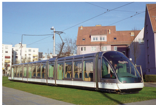
Fig. 8 - Con l' "Eurotram" di Strasburgo (1994) è cominciata l'epoca dei tram "multiarticolati", costituiti da carrozzini poggianti sui carrelli e da casse sospese tra un carrozzino e l'altro. Nell'Eurotram i carrozzini di estremità ospitano soltanto le cabine di guida. With the Strasbourg "Eurotram" (1994) the era of the "multi-articulated" trams began, made up of small carriages integral with non-pivoting bogies and suspended bodies between the formers. In the Eurotrams, the end small carriages house the driver's cabs only.
