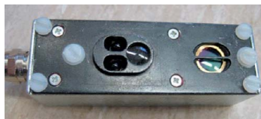
Fig. 9 - Sensore infrarosso attivo e passivo. Active and passive infra-red sensor.
