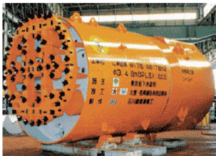
Foto 30 da [11] - Tokio: ricostruzione di canalizzazioni; diametro: 3,48 m.
