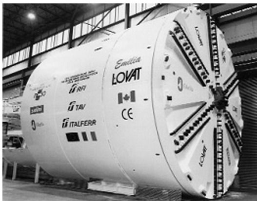
Foto 13 – TBM-EPB per lo scavo delle gallerie ferroviarie del nodo di Bologna.
