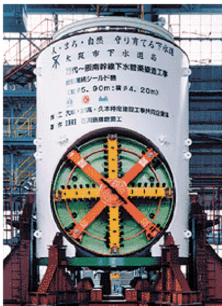
Foto 34 da [11] - Costruzione condotta fognaria di Bandai-Hannan (Vertical-to-horizontal shield machine). Scudo verticale Slurry shield: Ø 5.90 m; Scudo orizzontale EPB: Ø 4.20 m.
