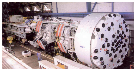
Foto 5 – TBM aperta con due coppie di gripper.
