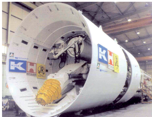
Foto 7 – SM a sistema aperto con fresa ad attacco puntuale.
