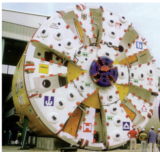
Foto 15 - Hydroschild Ø 14,14 m per lo scavo dell'Elbtunnel (Amburgo-Germania).
