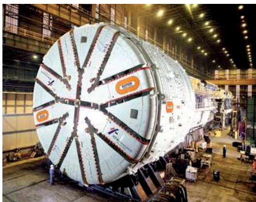
Foto 16 - Hydroschild Ø 14,87 m per lo scavo della galleria Groene Hart (Olanda).
