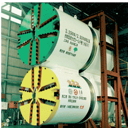
Foto 27 da [11] - Costruzione collettore fognario di Minami-dai. Lunghezza: 154 m; Diametro scudi: Scudo superiore: 3,29 m; Scudo inferiore: 2,89 m; Tipologia scudi: Slurry.
