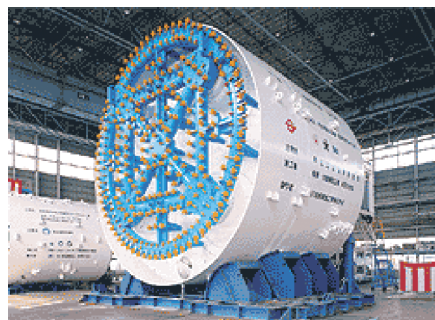
Foto 31 da [11] - Tokio: Costruzione linea metropolitana n. 11: diametro: 9,6 m.
