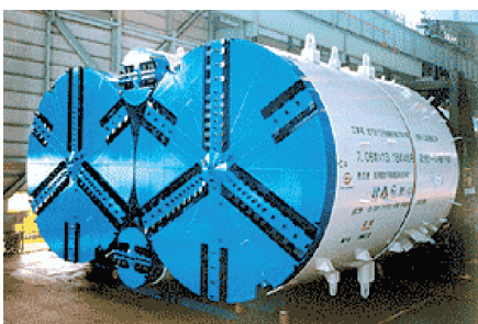
Foto 28 da [11] - Costruzione della stazione metropolitana di Roppongi linea n. 12 - Lunghezza: 118 m; Diametro scudi: Scudi destro e sinistro: 6,56 m; Scudi inf. e sup.: 1,72 m; Dimensioni sistema: 13,18 x 7,06; Tipologia scudi: Slurry.
