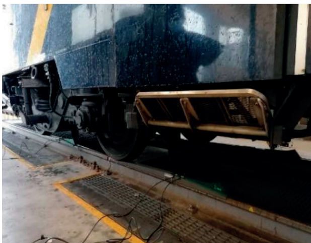
Figura 8 – Prove in campo: pesatura del carrello campione, pesatura di altri veicoli sulla pesa fissa e all'esterno. Figure 8 – Field tests: weighing of the sample bogie, weighing of other vehicles on the fixed scale and outside.
