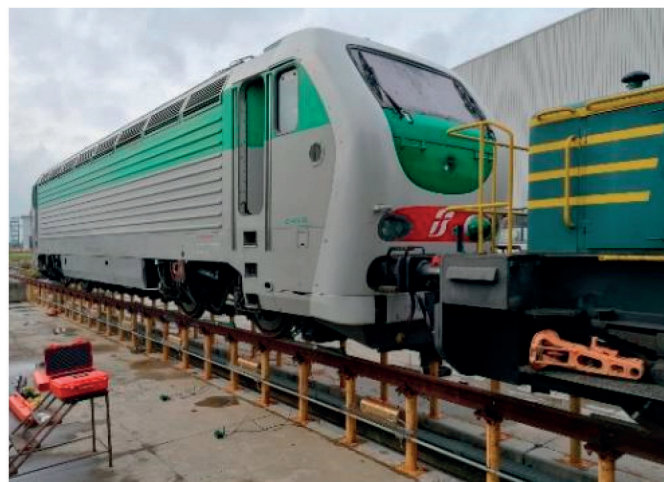
Figura 8 – Prove in campo: pesatura del carrello campione, pesatura di altri veicoli sulla pesa fissa e all'esterno. Figure 8 – Field tests: weighing of the sample bogie, weighing of other vehicles on the fixed scale and outside.
