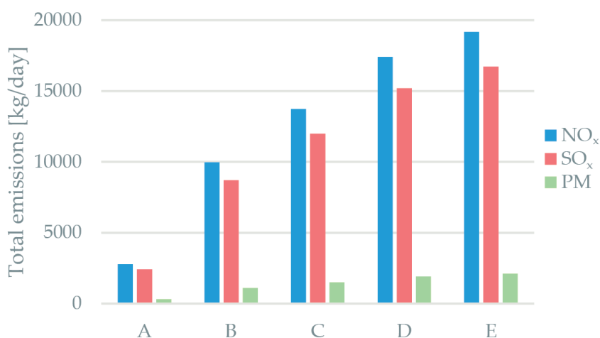
Figura 12 – Emissioni totali di NO x , SO x e PM per classe di navi da crociera [kg/giorno].
