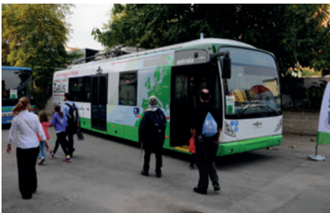
Fig. 4 - Filobus full Electric Van Hool A330T - Vossloh Kiepe nello speciale allestimento a due porte per CTM Cagliari. (Foto: Tonci MALETIĆ)
