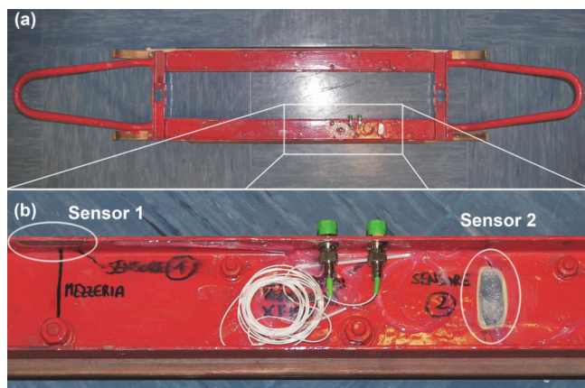
Fig. 5 - Testa del pantografo con i sensori FBG: (a) vista completa; (b) dettaglio dei sensori, con il principale (1) e con quello per la compensazione termica (2).
