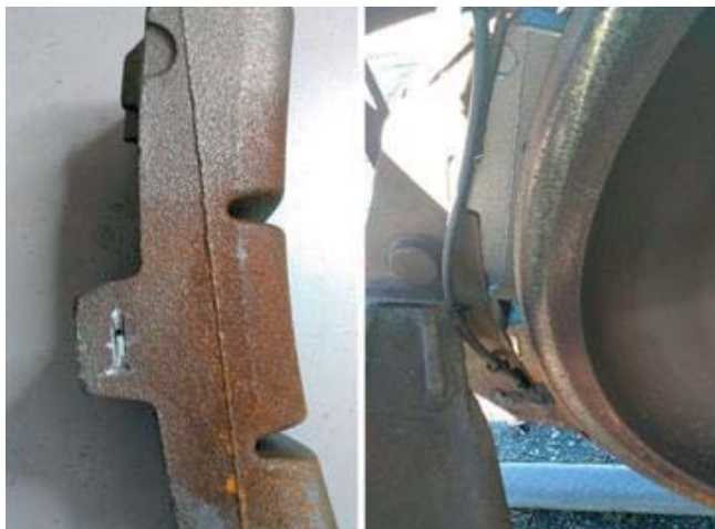
Fig. 7 - Sensorizzazione suola freno. Fig. 7 - Brake block sensorization.
