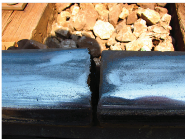
Figura 4 - Giunto di collegamento danneggiato. Figure 4 - Damaged connection joint.
