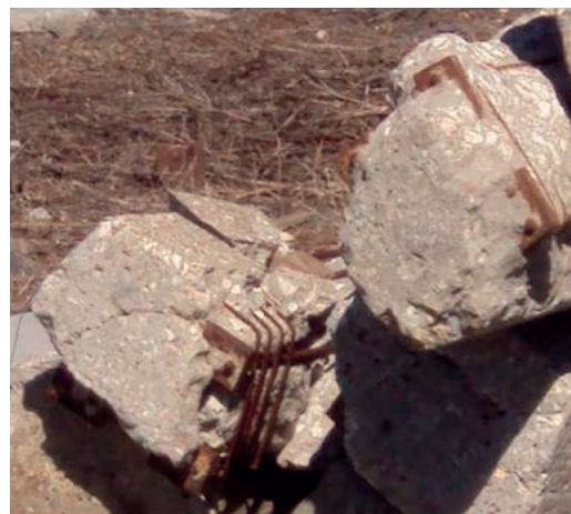
Fig. 12 – Traverse FS – Particolari delle staffature di testata e degli ancoraggi. FS sleepers – Details of head brackets and anchorages.
