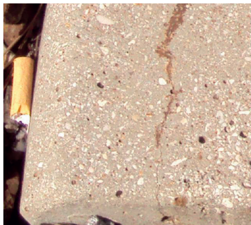
Fig. 11 – Traversa FS – Lesione longitudinale in testata. FS sleeper – Longitudinal lesion at the head.
