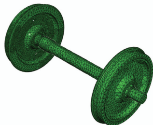
Fig. 9 - Modello agli elementi finiti della sala dinamometrica. Finite element model of the dynamometric wheel-set.
