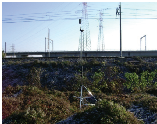
Fig. 12 - Indagine 1 - Installazione del microfono a ridosso di un rilevato prossimo al ponte storico di Ostiglia sulla linea BO-VR. Test n. 1 - Installation of microphones in an embankment section of the line BO-VR, near the historical bridge of Ostiglia.
