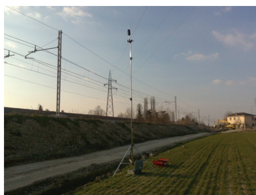
Fig. 23 - Indagine 3 - Installazione del microfono a ridosso di un rilevato prossimo al nuovo ponte di Ostiglia sulla linea BO-VR. Installation of a microphone in an embankment section area near the new bridge of Ostiglia along the railway line BO-VR.
