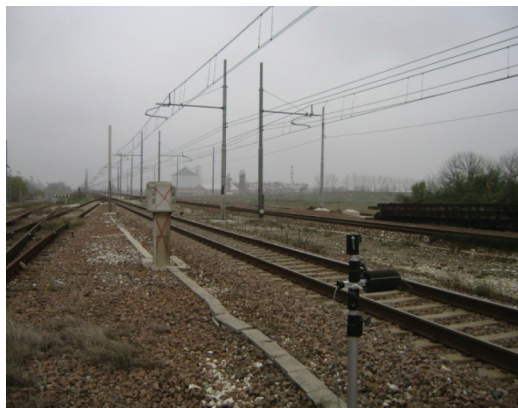
Fig. 19 - Indagine 2 - Installazione del microfono a ridosso di un rilevato prossimo al ponte di Pontelagoscuro (FE) sulla linea BO-PD. Test n. 2 - Installation of microphones in an embankment section area near the bridge of Pontelagoscuro (FE), along the railway line BO-PD.
