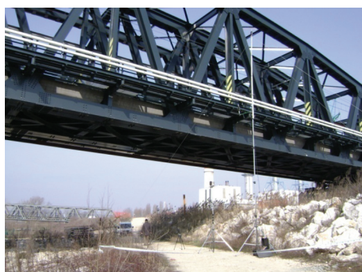
Fig. 22 - Indagine 3 - Installazione dei microfoni a ridosso del nuovo ponte di Ostiglia (MN) sulla linea BO-VR. Test n.3 - Installation of microphones near the new bridge of Ostiglia (MN), along the railway line BO-VR.
