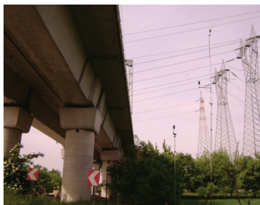
Fig. 29 - Indagine 4 - Installazione dei microfoni a ridosso di un viadotto in cemento armato precompresso sulla nuova linea BO-VR. Test n. 4 - Installation of microphones near a pre-compressed reinforced concrete viaduct along the new railway line BO-VR.
