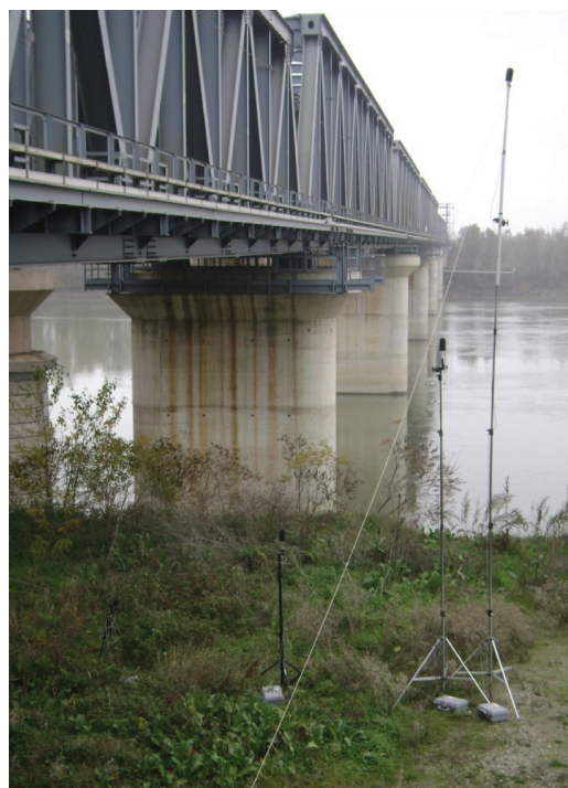
Fig. 18 - Indagine 2 - Installazione dei microfoni a ridosso del ponte ad attacco diretto di Pontelagoscuro (FE) sulla linea BO-PD. Test n. 2 - Installation of microphones near the non ballasted permanent way bridge of Pontelagoscuro (FE), along the railway line BO-PD.
