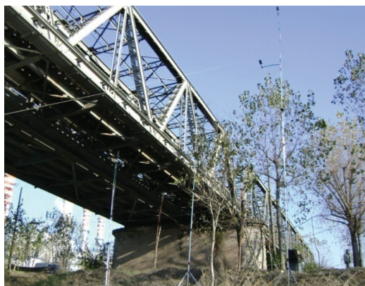
Fig. 11 - Indagine 1 - Installazione dei microfoni a ridosso del ponte ad attacco diretto di Ostiglia (MN) sulla linea storica BO-VR. Test n. 1 - Installation of microphones near the non ballasted-permanent way bridge of Ostiglia (MN) along the historical line BO-VR.
