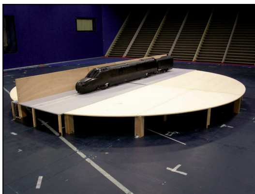
Fig. 37 – Modello in prova in galleria del vento [iii].
