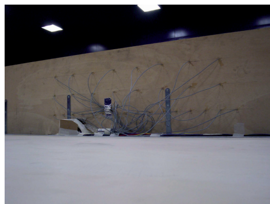
Fig. 38 – Distribuzione dei 32 trasduttori di pressione sul modello della barriera - Vista dal lato esterno della barriera [iii].
