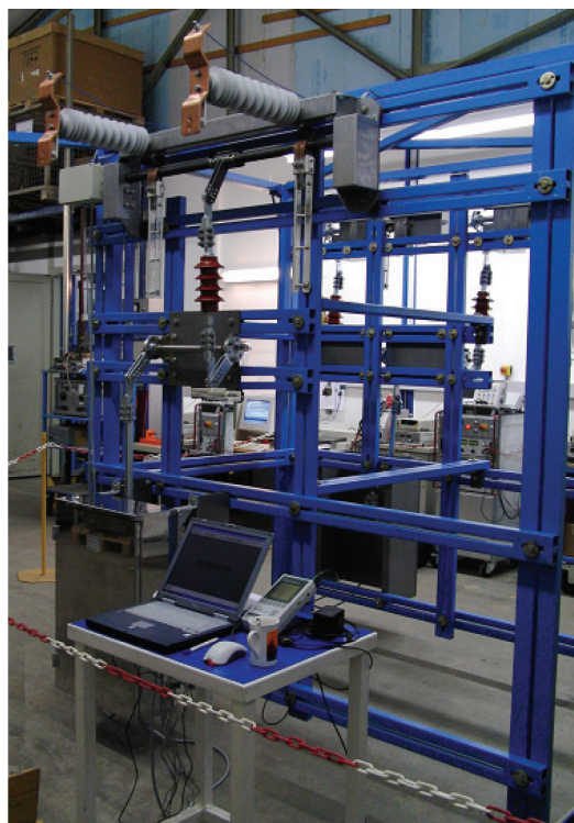
Fig. 29 – Sezionatore MAT durante le prove di tipo. Earthing disconnect switch during tests.
