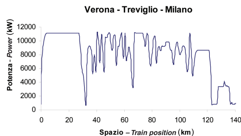
Fig. 15 – Andamento della potenza assorbita dal treno, binario pari. Change in power absorbed by train: up line.
