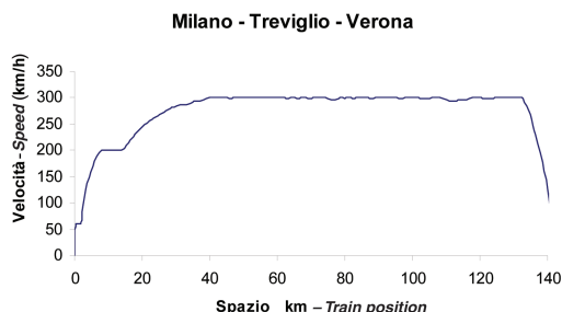
Fig. 12 – Andamento della velocità di marcia, binario dispari. Change in transit speed: down line.
