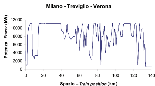
Fig. 14 – Andamento della potenza assorbita dal treno, binario dispari. Change in power absorbed by train: down line.
