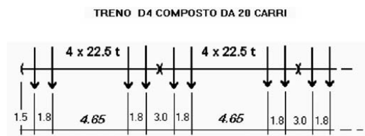
Fig. 25 - Schema di convoglio di carri D4 previsto per l'analisi di risonanza.
