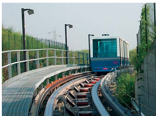
Fig. 17 - Impianto APM "Poma 2000" a Milano, con trazione a fune, in esercizio a va e vieni.
