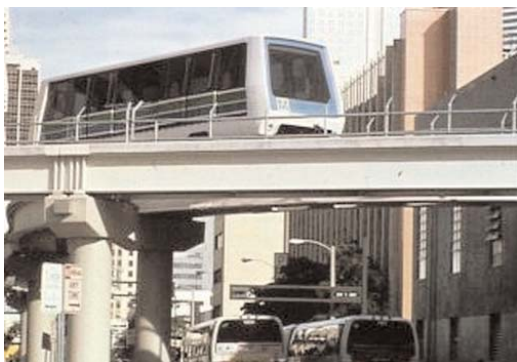
Fig. 10 - L'AEG Westinghouse Metromover di Miami (USA) caratterizzato da veicolo singolo, con motorizzazione a bordo veicolo.
