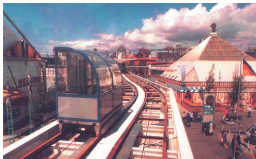
Fig. 14 - Il sistema SK, a fune, di Villepinte (Francia), con motorizzazione presso una stazione.
