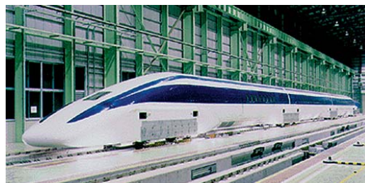
Fig. 20 - Il veicolo MLX01 del sistema Maglev giapponese, ultimo dei prototipi finora prodotti.
