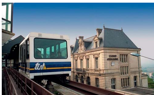
Fig. 15 - Il sistema POMA 2000, a fune, di Laon (Francia), con motorizzazione presso una stazione.
