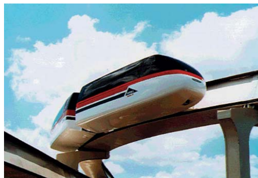
Fig. 8 - Prototipo della monorotaia con sospensione laterale System 21 Monobeam Technology.
