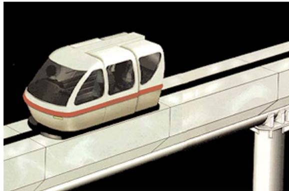
Fig. 23 - Illustrazione del sistema Raytheon PRT2000.
