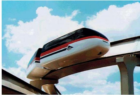
Fig. 8 – Prototipo della monorotaia con sospensione laterale *System 21 Monobeam Technology*.
