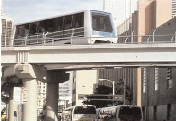
Fig. 10 – L’AEG Westinghouse *Metromover* di Miami (USA) caratterizzato da veicolo singolo, con motorizzazione a bordo veicolo.
